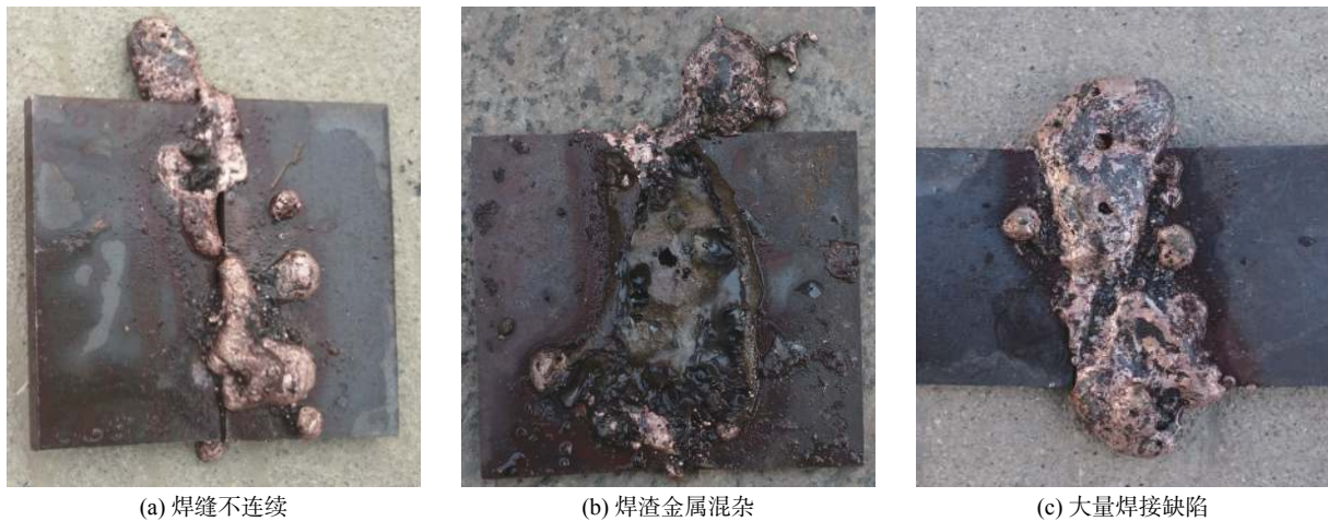
图3 水下手工自蔓延焊接试件
