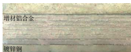
图 2 铝钢过渡接头表面形貌
